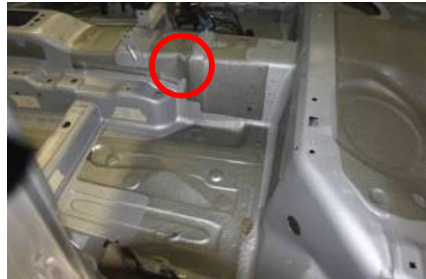
Bild 7: Knick im Mitteltunnel (rote Markierung)
