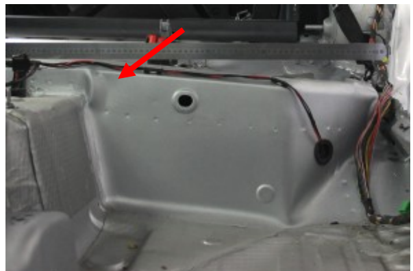
Bild 20: Konsole der Rücksitze nach Zweitcrash
