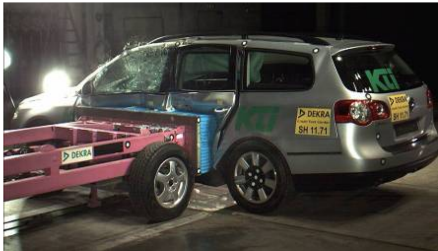
Seitencrash eines fachgerecht reparierten Pkw
