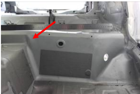
Bild 19: Konsole der Rücksitze nach Erstcrash
