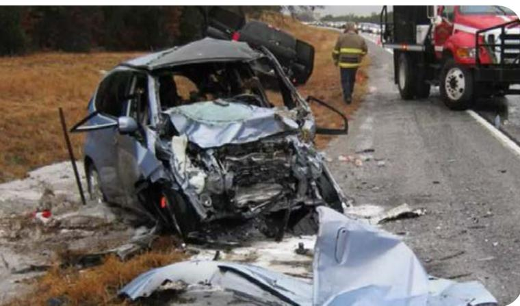
Nach einem Hagelschaden erhielt dieser Honda Fit ein neues Dach. Im Reparaturbetrieb wurde das Dach mit der Carrosserie verklebt statt verschweisst, wie es der Hersteller vorschreibt. Die Reparaturmethode soll auf Drängen des leistungspflichtigen Versicherers gewählt worden sein, heisst es. Die unkorrekte Reparatur erwies sich bei einer späteren Frontalkollision als fatal für die Insassen.
